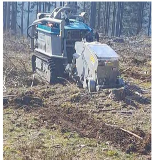
Streifenweise Bodenvorbereitung mittels Forstraupe mit angebautem Fräs- und Sähaggregat (ThüringenForst 2025).
